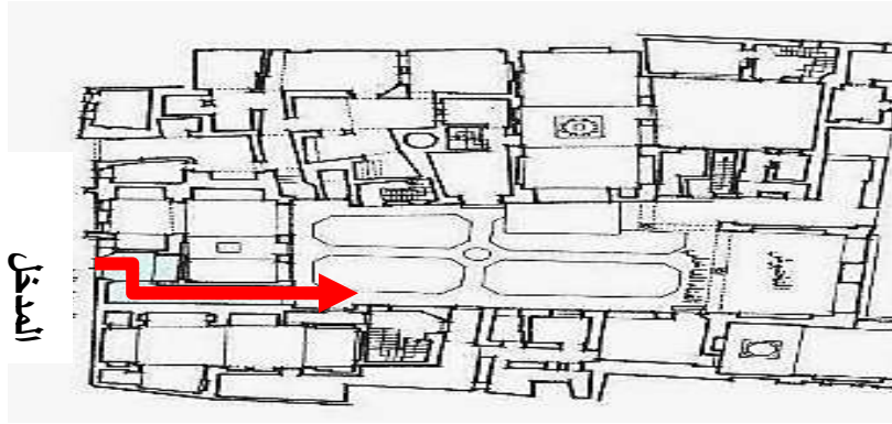
شكل رقم (٣) يوضح مسقط أفقي لبيت السحيمي موضح عليه فكرة استخدام مدخل البيت المنكسر المؤدي الي صحن البيت مراعاة لخصوصية اهل البيت. (عمارة الارض ٢٠١٤)
