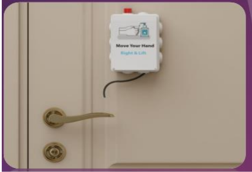
شكل رقم (٩) يوضح الجهاز المقترح لتعقيم المقبض وتركيبه على الباب اعلى المقبض المعدني
